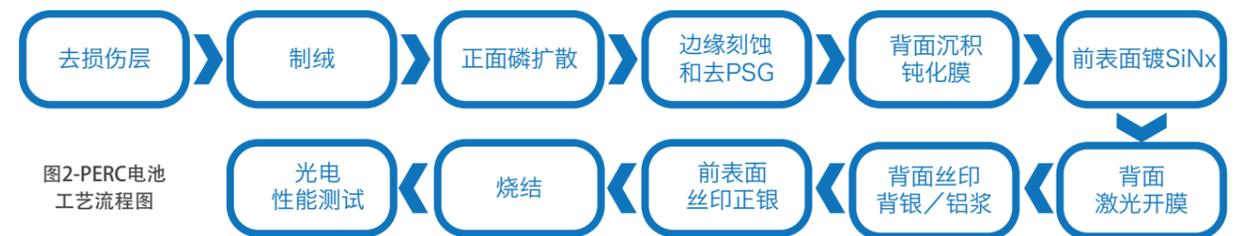
图2-PERC电池工艺流程图
