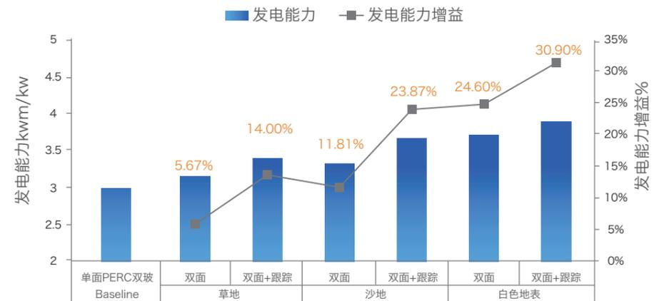
图21-天合光能单面PERC组件和双面PERC组件发电量对比
