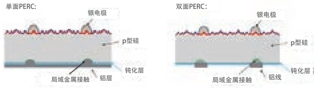
图18-单面PERC电池与双面PERC电池结构
