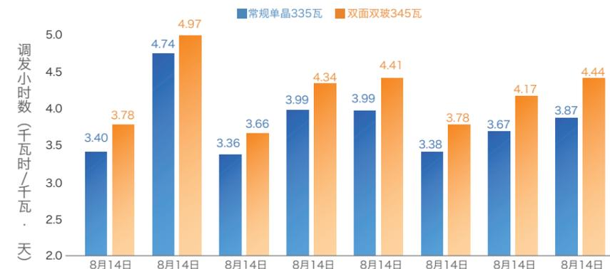
图22-黄河晨阳100MW光伏电站项目PERC双面组件与常规组件发电量对比
